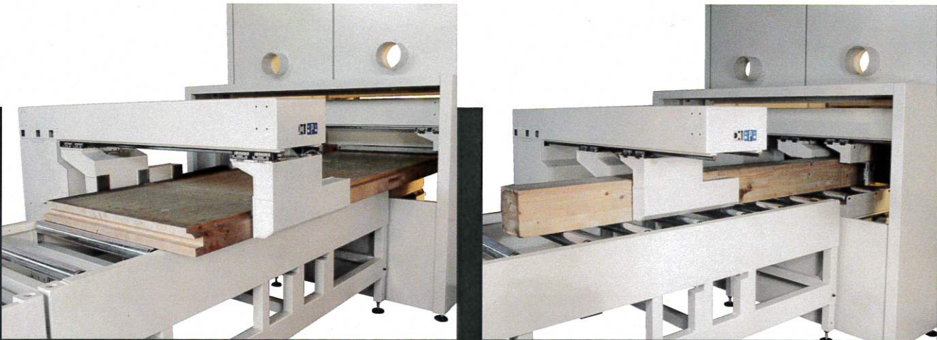
Zwei motorisierte Spannanzgen, eine am Einlauf und eine am Auslauf, garantieren die Bewegung des Balkens in jeder Lage. Vom Einlaufbereich über den Bearbeitungsbereich bis zum Auslaufbereich wird der Leimbinderorschub dank der synchronisierten Bewegung der Spannanzgen nie unterbrochen.
