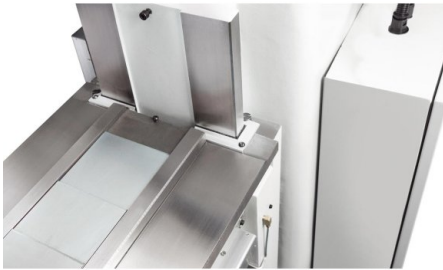
Breite, stabile Flachführungen in Z- und Y- Achse
