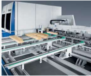
Ein- und Auslaufautomatisierung für "Mannarme" Fertigung
