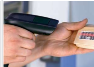
Werkstückerkennung mit Barcode-label
