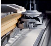
Power satt: Hauptspindel mit bis zu 30 kW
