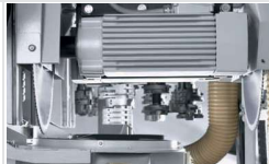
Sägeaggregat zum Ablängen in der Maschine
