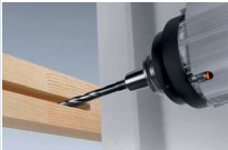
Horizontales Fräsaggregat für große Ausfräsungen, wie z.B. Schlosskasten
