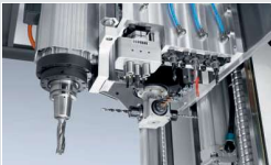
Kombination Mehrspindelbohrkopf horizontal/vertikal mit vertikalem Fräser
