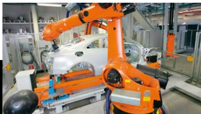
La medición en línea de carrocerías de automóvil: una de la infinidad de posibles tareas que pueden realizar estos robots.
