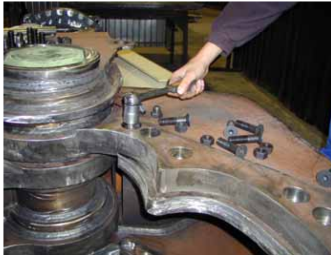
Abbildung 5: An-/ Nachziehen der Messerschrauben
