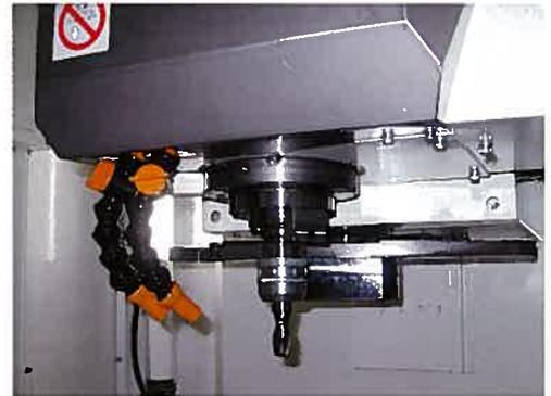
**Kitamura Original Werkzeugwechsler / ATC-System**
