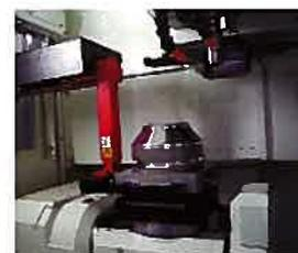
Ein System mit 7 Arbeitsstationen kann optional installiert werden. Damit kann die Produktionseinheit über Stunden in mannlosen Schichten zum Einsatz kommen.
