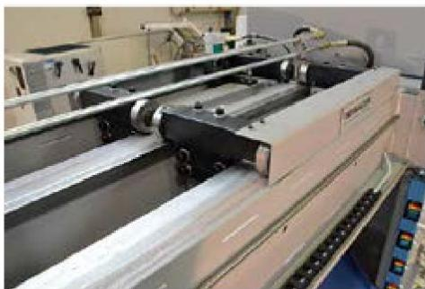
Vertikale Slider, verschiebbar
