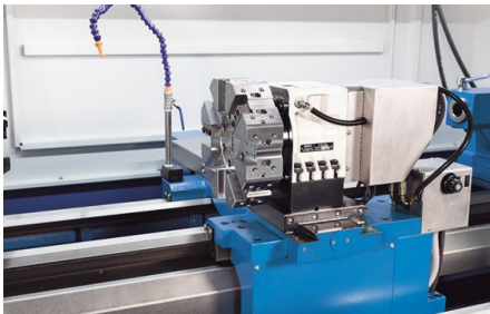
Automatischer 8-fach-Werkzeugrevolver mit hydraulischer Klemmung
