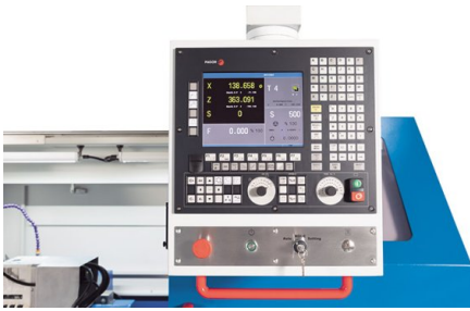
Die Fagor 8055 CNC-Steuerung bietet zusätzlich eine intuitive Werkstattprogrammierung über einfachen, grafikunterstützten Tastendialog
