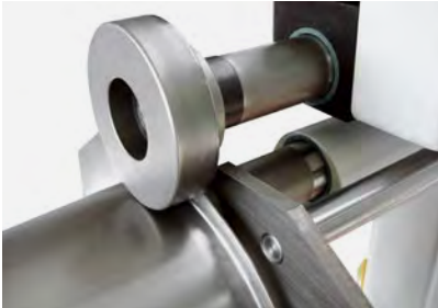
Bördelwalzen FL: Flanschen ohne Hochschwenken des Teils
