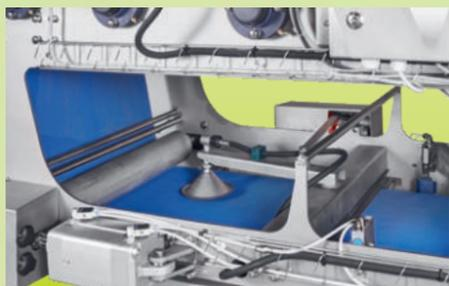
Hochdruck-Bandreinigung intervallgesteuert am Display einstellbar
