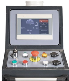
Intuitive Steuerung mit großem Touchscreen und drei Betriebsmodi: Manuell/Halbautomatik/Automatik
