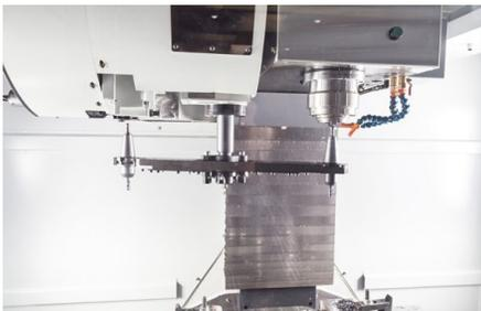
Werkzeugwechsler mit Doppelarm und Spindel
