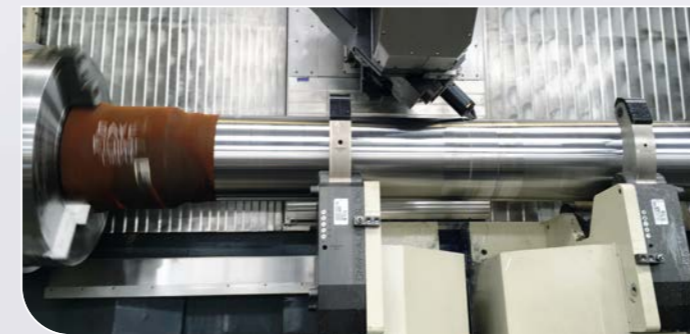
Hydraulische Lünetten mit unabhängiger Steuerung
