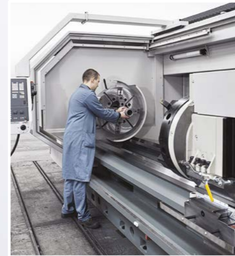
Einfacher Zugang zum Arbeitsraum, geringer Abstand zur Maschinenachse
