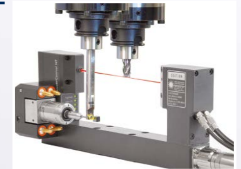
▲ Duales Werkzeugmesssystem: Lasertaster zum Messen von angetriebenen Werkzeugen und Tastsystem für starre Werkzeuge
