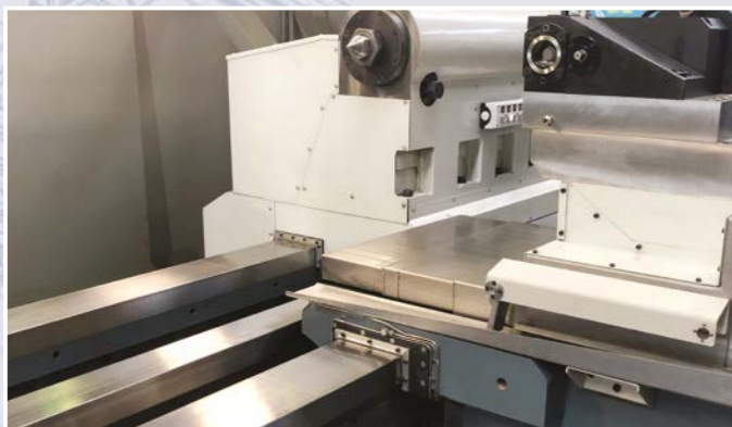
Schlitten ohne Kollision mit dem Reitstock
