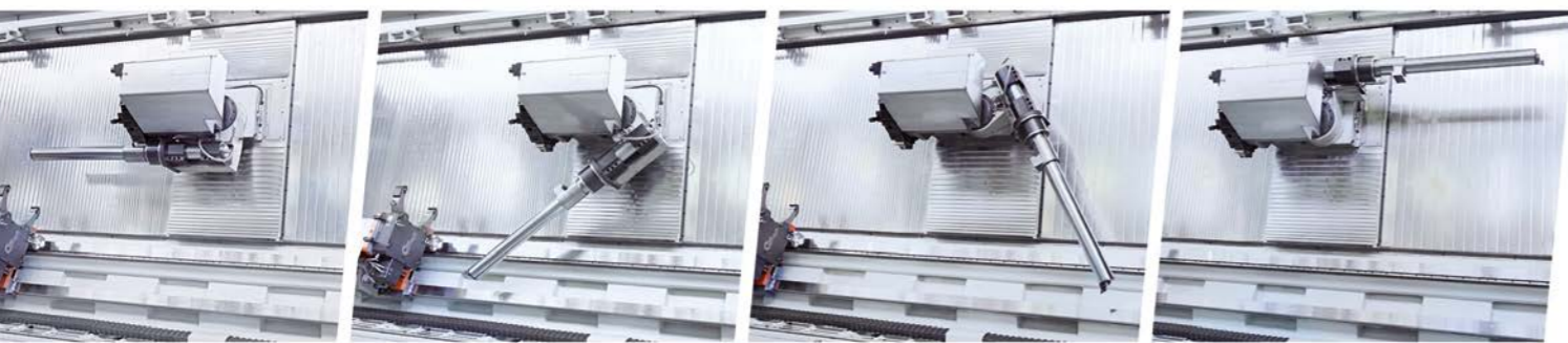
Spezieller Bohrstanthalter. Das Gerät ist für eine Bohrstanze mit einem maximalen Durchmesser von 120 mm vorbereitet. Die Bohrstanze ist in einem drehbaren Halter montiert, der es ermöglicht, die Bohrstanze ohne Demontage in die Parkposition zu bringen.
