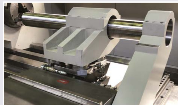
Bohrstangenhalter montiert auf Nullpunkt- Spannsystem
