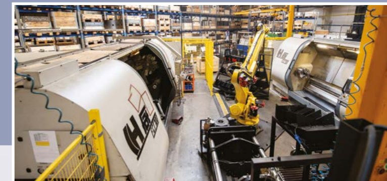
Zwei FCT700 x 2100 Maschinen, die mit einem integrierten Roboter arbeiten
