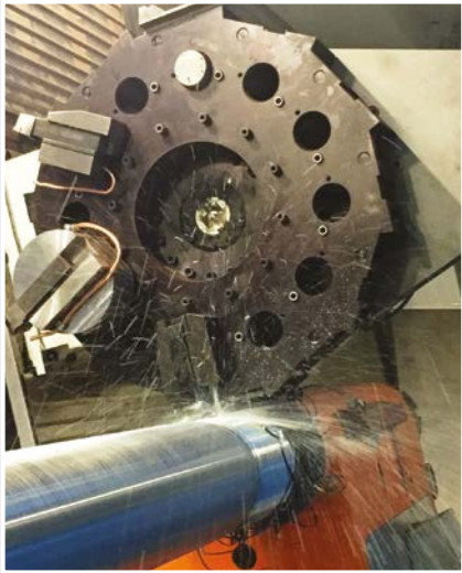
Revolver mit Sonderscheibe mit Axial- und Radialsitzen für angetriebene und feste Werkzeuge
