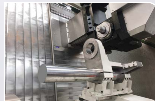
Bohrstanthalter montiert auf dem Dreh-Fräskopf mit B-Achse. Parken auf der Gegenspindel ermöglicht eine schnelle Montage.
