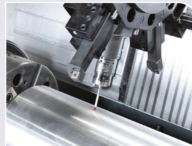
Der Werkstückmesstaster in der Revolveraufnahme montiert
