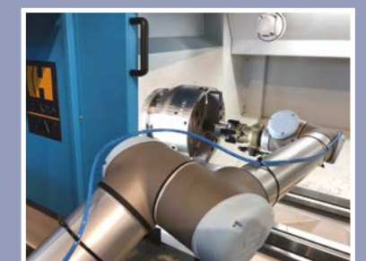
Hydraulisches Futter in Zusammenarbeit mit einem Roboter
