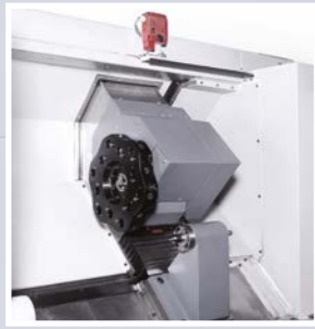
Standard 12-fach Scheibenrevolver für statische Werkzeuge VDI30
