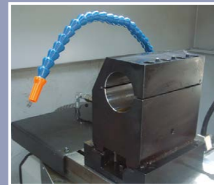
Bohrstangenhalter auf T-Nuten montiert
