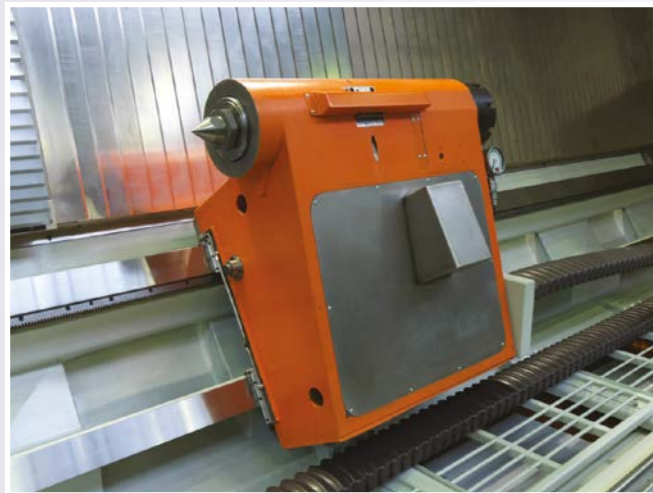
Hydraulischer Reitstock mit automatischer Klemmung zum Bett. Kann mit separatem CNC-Antrieb ausgestattet werden
