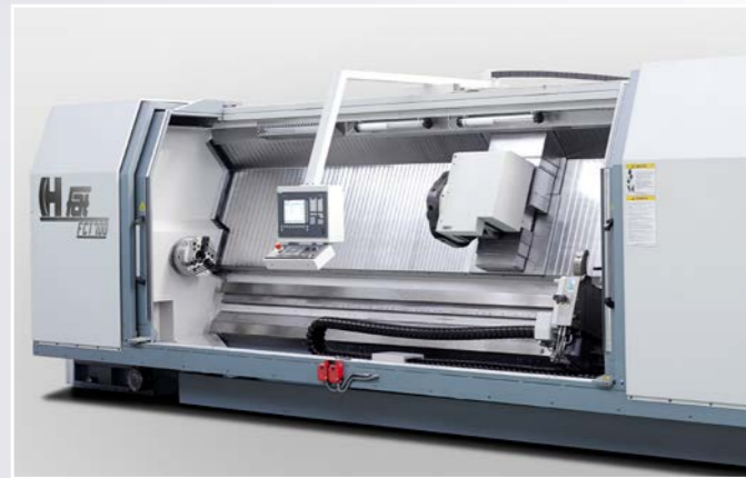
FCT700 - 5.100 mm Drehlänge. Automatische Tür. Unabhängiger CNC-Antrieb für Reitstock und hydraulische Lünette. Revolver mit angetriebenen Werkzeugen.
