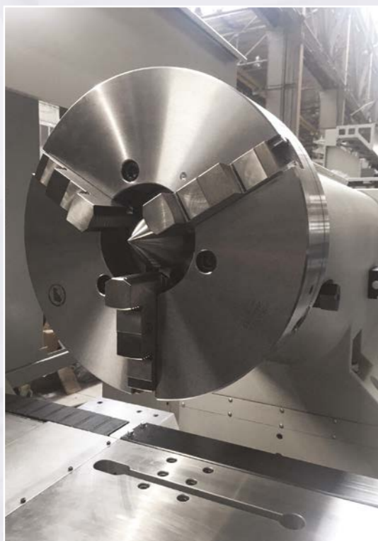
Reitstockpinole mit der Möglichkeit zur Befestigung eines Futters
