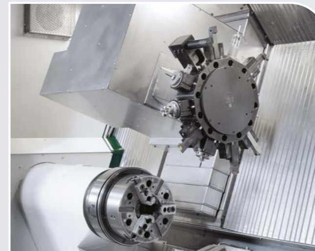
Werkzeugkopf mit radial angetriebenen Werkzeugaufnahmen und integrierter Y-Achse
