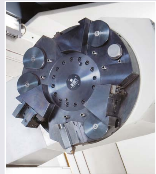
Sonderscheibe mit Sitzen für die Bohrstanthalter
