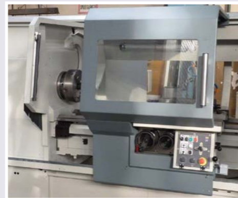
Ein zusätzliches Steuerpult auf dem Support erleichtert die Arbeit im manuellen Modus
