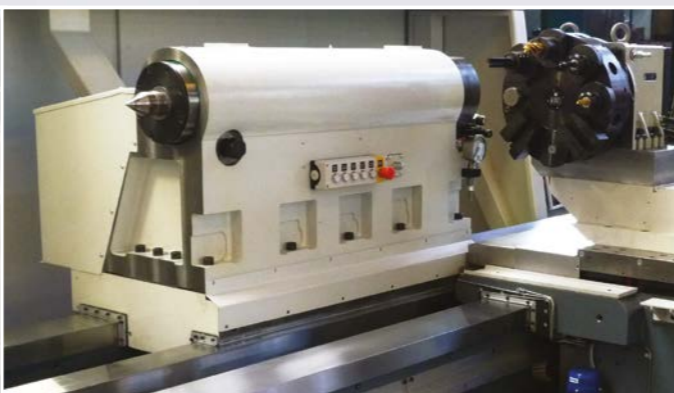
Schlitten ohne Kollision mit dem Reitstock
