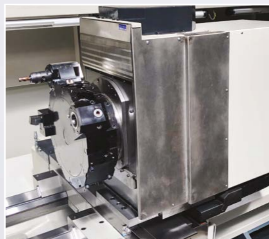
Werkzeugrevolver mit angetriebenen (BMT)Sitzen und mit integrierter Y-Achse
