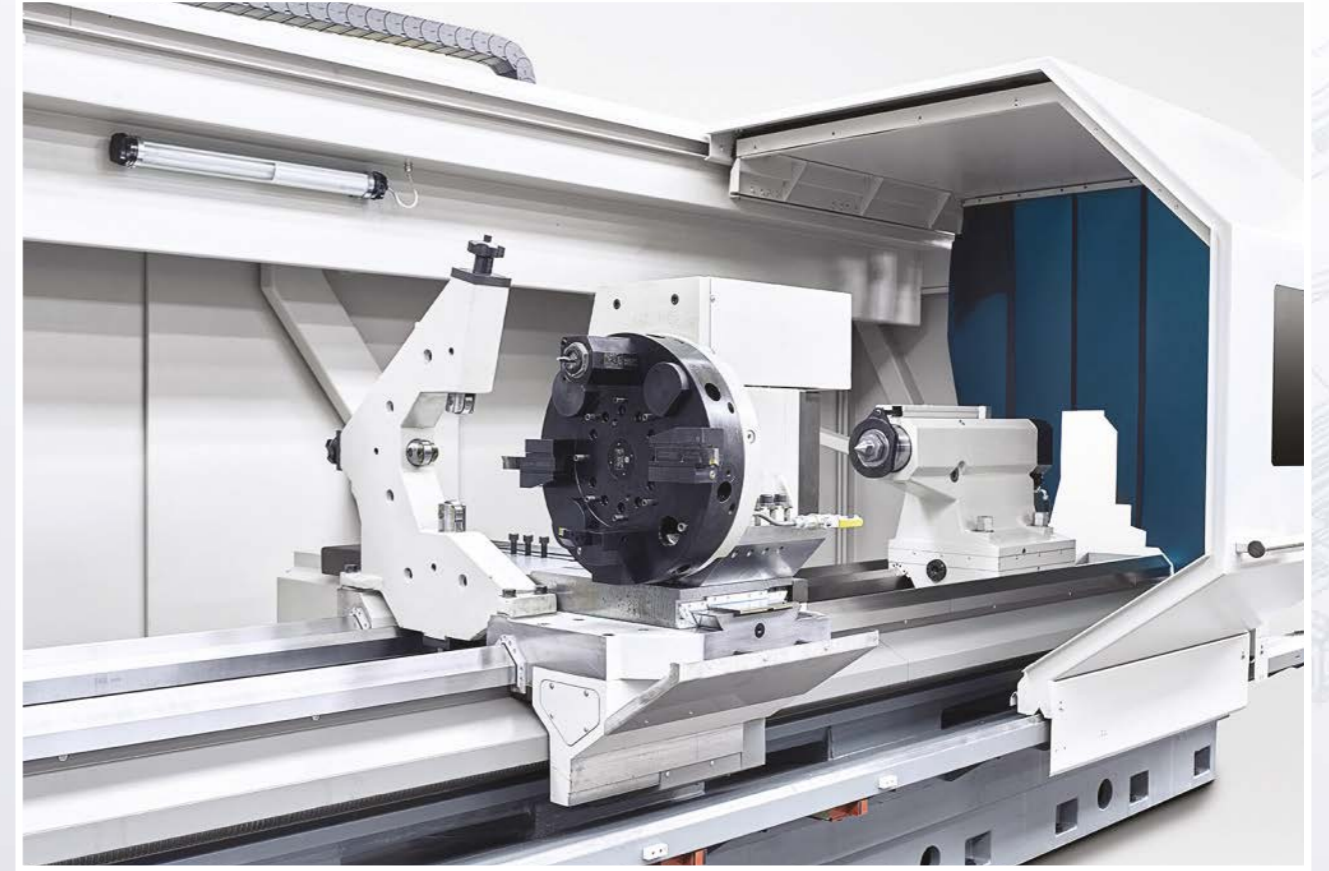
Eine große Auswahl an Lünetten ermöglicht es Ihnen, den Bearbeitungsprozess zu optimieren. Es gibt manuelle, hydraulische Lünetten - selbstzentrierend, auf dem Bett montiert oder mit dem Schlitten verfahrbar, sowie mit automatischer Zufuhr zur Maschinenachse.
