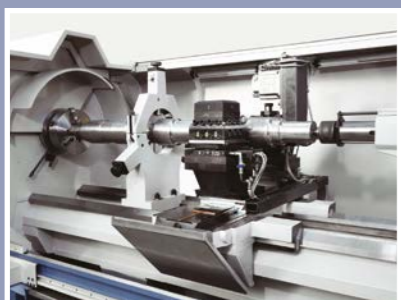
Werkzeugrevolver und Fräseinheit auf der gegenüberliegenden Seite der Drehachse
