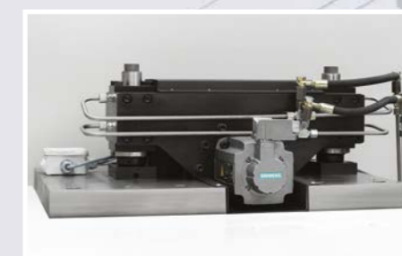
C-Achse mit unabhängigem Direktantrieb der Spindel ermöglicht eine präzise Fräsbearbeitung mit Interpolation des Werkstücks
