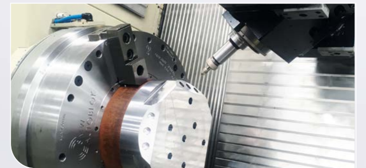
Pneumatisches Futter mit Durchgang 360mm
