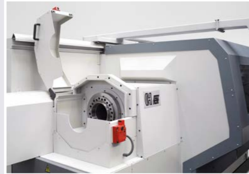
Große Spindelbohrung von 165 mm und hintere Spindel Nase mit Abdeckung.
