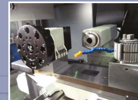
WTO-Werkzeugsystem zum Drehen, Bohren und Fräsen. Optionale Y-Achse mit einem Hub von +/- 10 mm
