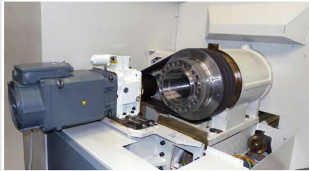
Direkter Spindeltrieb über 2-Stufen-Planetengetriebe.
