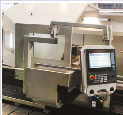
Vordertür mit dem Schlitten gekoppelt
