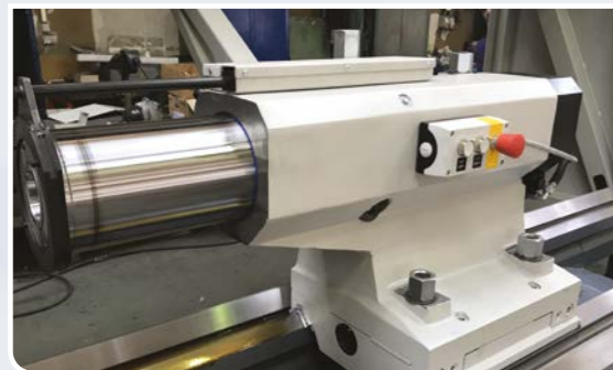
Reitstock mit unabhängigem Antrieb
