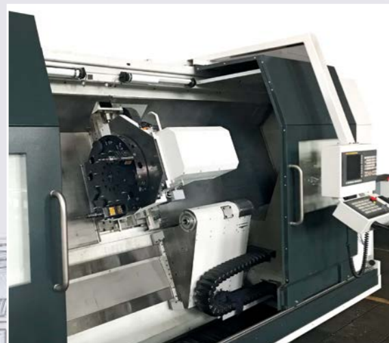
FCT 700 x 1600 mit 12-fach Werkzeugrevolver mit integrierter Y-Achse
