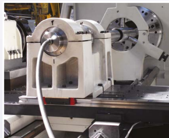
Halter auf T-Nuten montiert; für langen Bohrstangen
