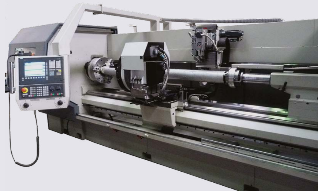
Ein zusätzliches Steuerpult auf dem Support erleichtert die Arbeit im manuellen Modus
