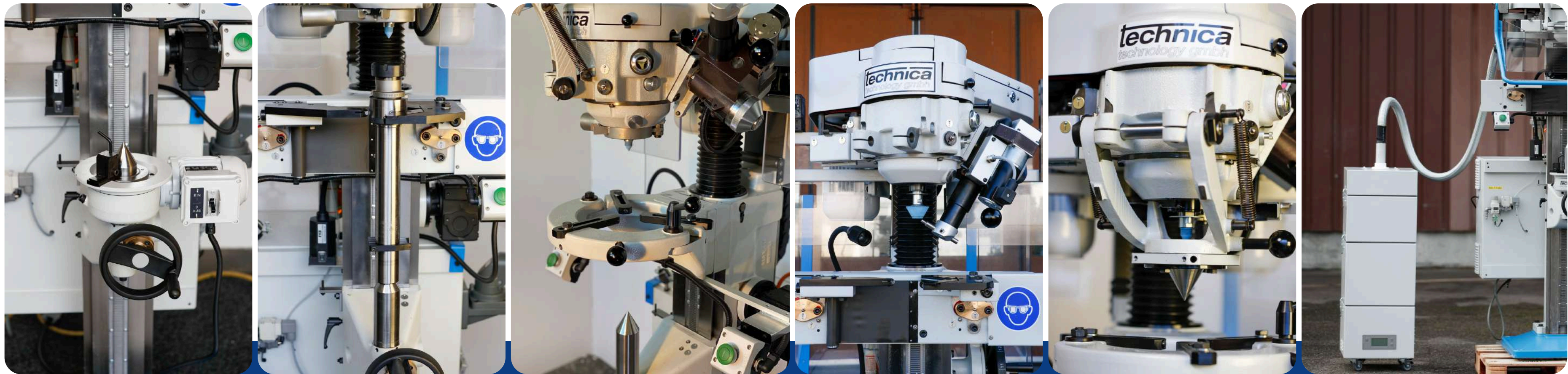
Entraînement de la pièce - Porte-pièce à pince - Lunette à trois points - Dispositif de dressage - Pointe excentrée - Système d'extraction de poussière
