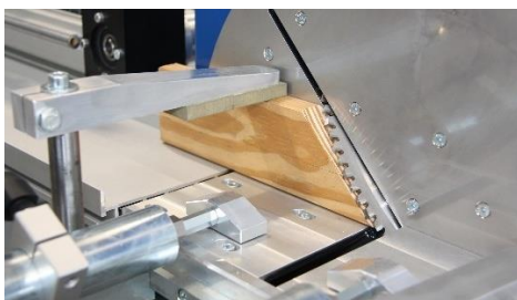
Élément de serrage combiné : activable et désactivable individuellement (boutons)
