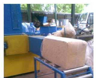
mütek Ballenpressen / Verpackungsmaschinen wurden zur Herstellung von Ballen aus verschiedensten Materialien wie z.B. zerkleinertem Micanthus bzw. Elefantengras, Holzspäne, Sägemehl und zerkleinertem Stroh entwickelt. Die Maschine zeichnet sich durch eine robuste Bauweise aus, die eine gleichbleibende Qualität im Dauerbetrieb garantiert.
