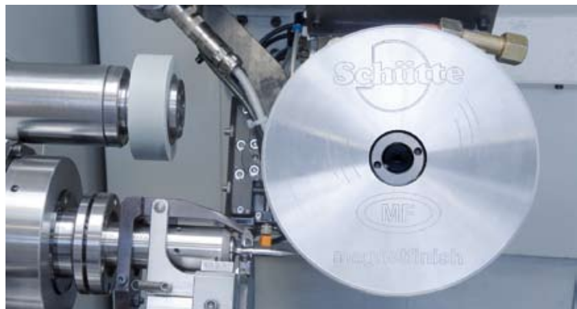
Schneidkantenpräparation in der Maschine mit dem Magnetfinishverfahren
