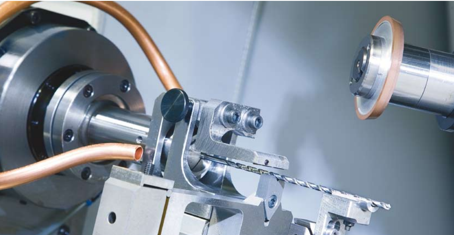
Das patentierte Werkstückführungssystem WFS sichert auch bei Werkzeugen mit großem L/D-Verhältnis (z.B. Tieflochbohrern) eine optimale Prozessführung
