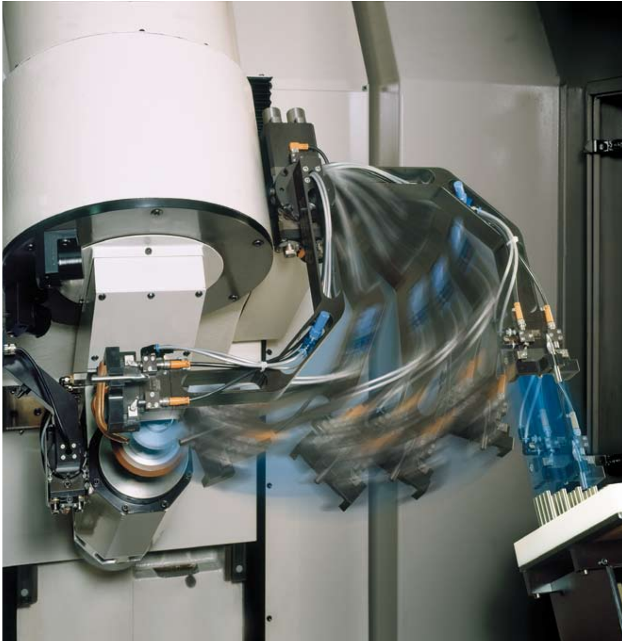
Automatische Werkstückbe- und -entladung mit dem Pick-Up-Lader
