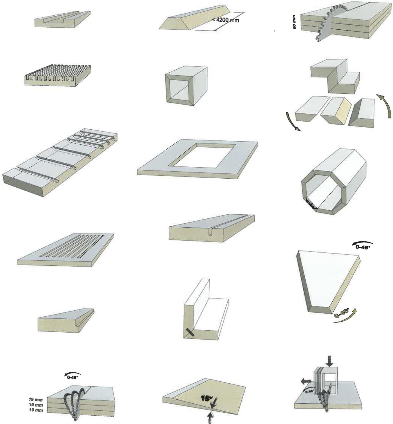
Da auf nur einer Maschine gleichzeitig Platten aufgeteilt und Gehrungen geschnitten werden, entfällt die Manipulation von einer Säge zur anderen. Das reduziert signifikant die Gefahr von Fehlern, Ungenauigkeiten und Beschädigungen.
