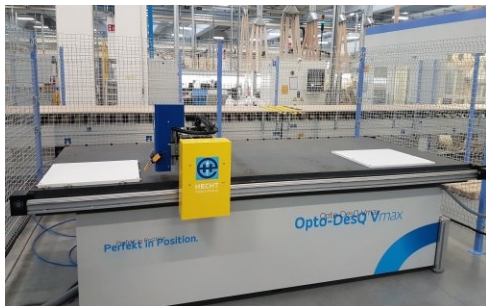
Mesa de medición directamente junto a la línea de taladrado en producción
