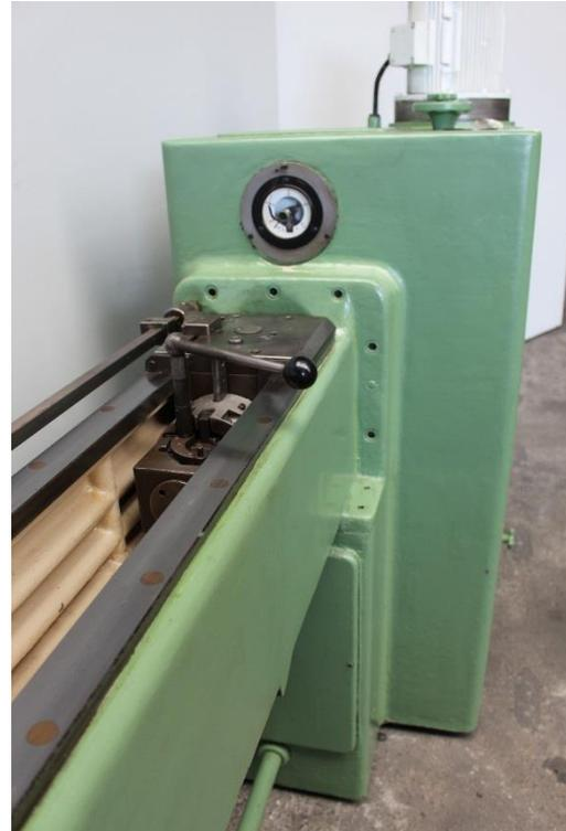
Führung mit Zugbrücke mit Ziehkopf
