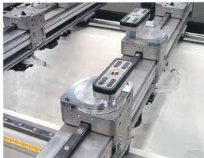
**FAT (Full Automatic Table).** Ein vollautomatischer Tisch, der mit Halterungen und Saugnapfen ausgestattet ist und imstande ist, sich in wenigen Sekunden in der für die betreffende Bearbeitung nötige Konfiguration zu positionieren.
