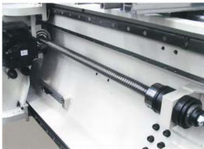
Die Bewegung der Achsen X, Y und Z erfolgt durch bürstenlose Motoren auf Kugelrücklaufschrauben; auf diese Art sind **Beschleunigungen und Abbremsen bis zu 5 m/sec<sup>2</sup>** mit absoluter Präzision bei der Positionierung möglich. Alle bewegliche Teile werden automatisch geschmiert und sind somit wartungsfrei.
