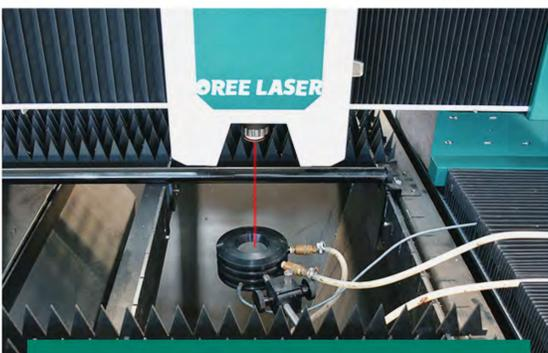
Laser Power Meter Test
