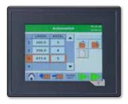
CutLink kann manuell oder automatisiert eingesetzt werden, wobei Sie 10 Zeilen mit Hinteranschlageinstellungen und Anzahl der nacheinander auszuführenden Schnitte programmieren können. Ihre Einstellungen werden im Speicher des Systems gespeichert. Mit CutLink steuern Sie das Blechauflagesystem, den Niederhalter und das kontinuierliche Schneiden.
