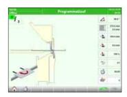
Der Bediener folgt der Biegereihenfolge auf dem Bedienpanel und erhält Anweisungen für die folgenden Schritte.
