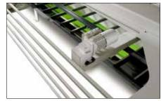
Bei angehobenem Niederhalter reicht der Abstand zwischen den Kugelgewindespindeln aus, um ein 1250 mm langes Blech durchzuziehen (nicht
