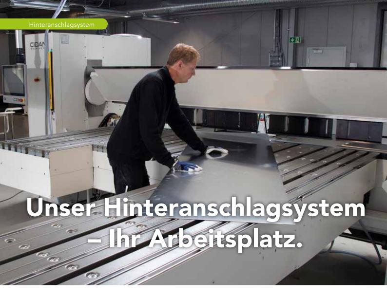
Unser patentierter Hinteranschlag bietet unschlagbare Präzision, ist extrem vielseitig und kann von 1.000 mm bis zu 4.300 mm Arbeitstiefe erweitert werden.
