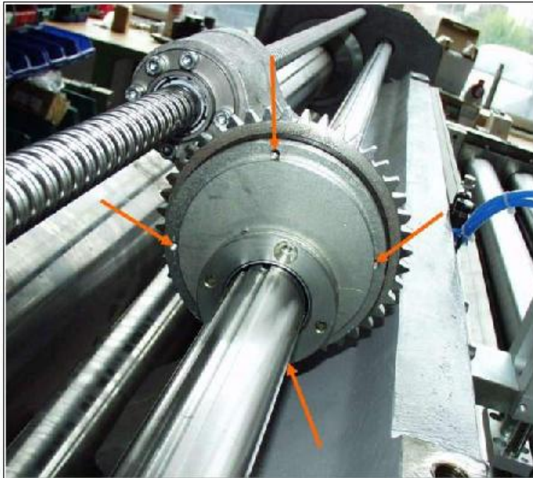
Abb.: 7.4.1.a Spannen bzw. Entspannen der Rutschkupplung
