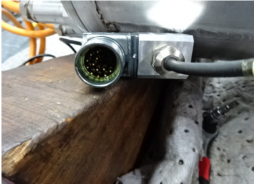
Bild 3.1: Makroaufnahme des Gebersteckers / encoder plug / presa ruota fonica
