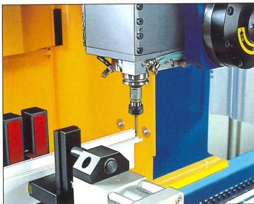
Fräsen eines in den Spannböcken gespannten Profils; der Fräsmotor ist stufenlos um die vertikale und horizontale Achse schwenkbar.
