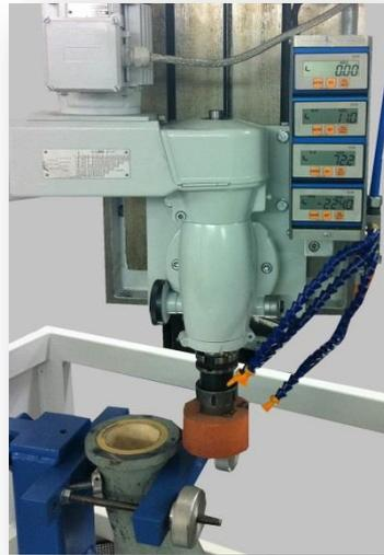
**Schleifmaschine zur Bearbeitung von Keramikrohren**
