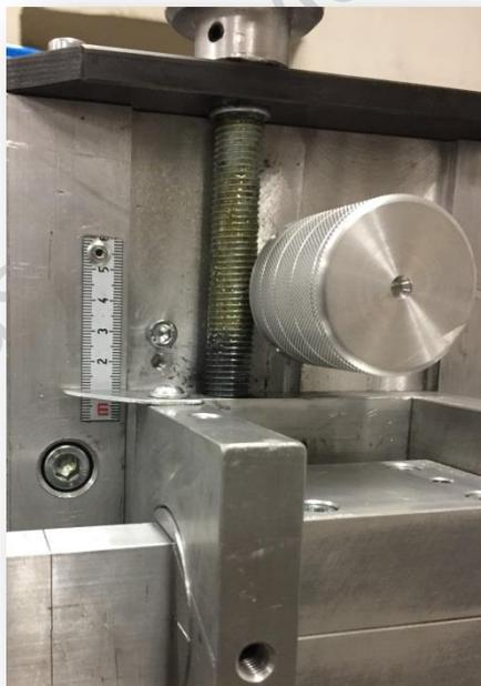
**Verstellspindel der Haltezange. Einstellung nach Skala.**
