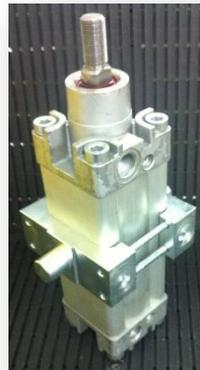
**Mittenbefestigung für Pneumatikzylinder**
