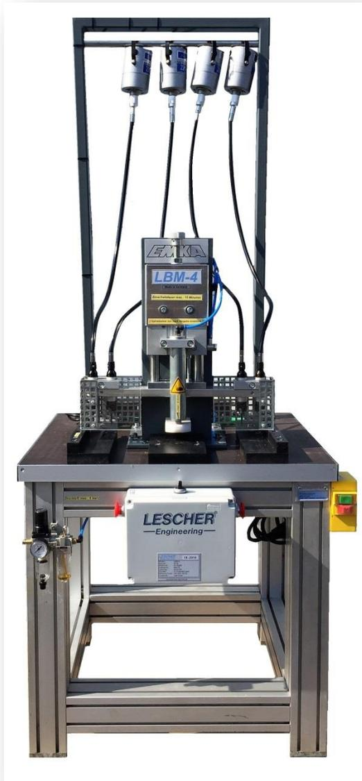
**Mehrspindel Bohrmaschine Modell LBM-4**
