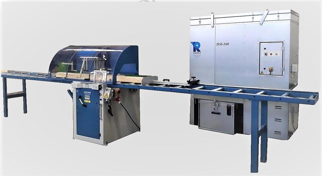
**Modell AS-800 mit Längenanschlag und Absauganlage**
