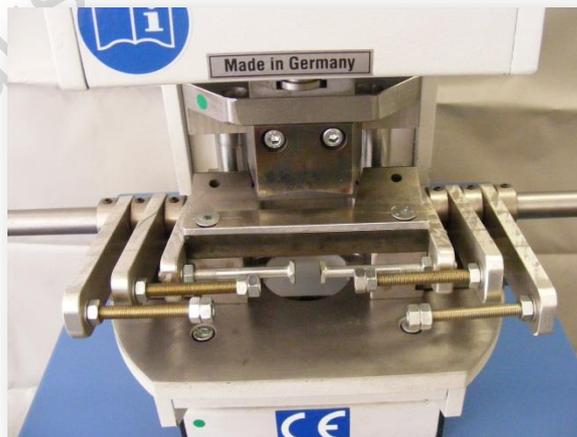
**Ausklinkwerkzeug für den Fensterbau**
