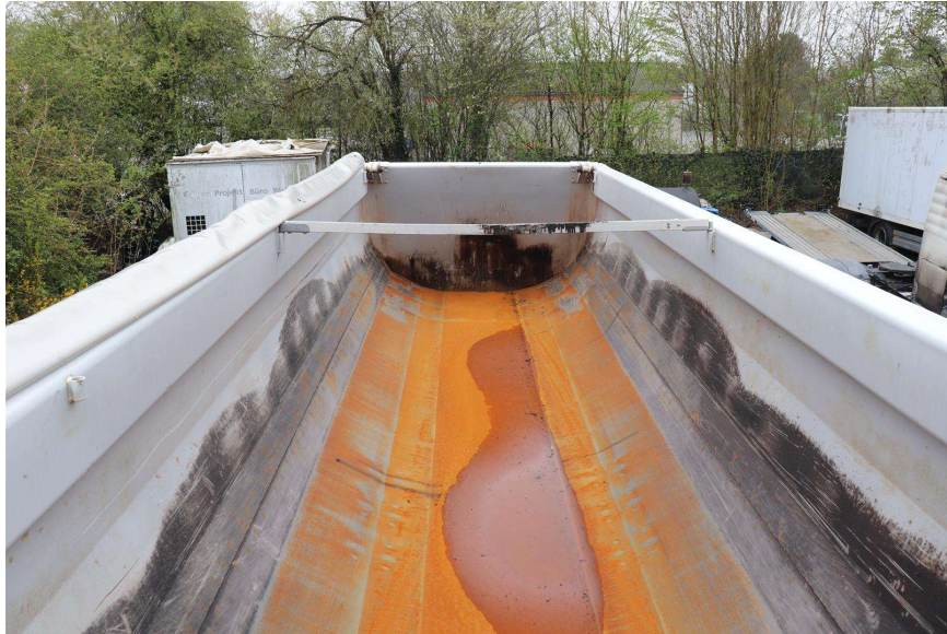
Bild 13 Einsatzbedingte Abschürfungen in der Mulde
