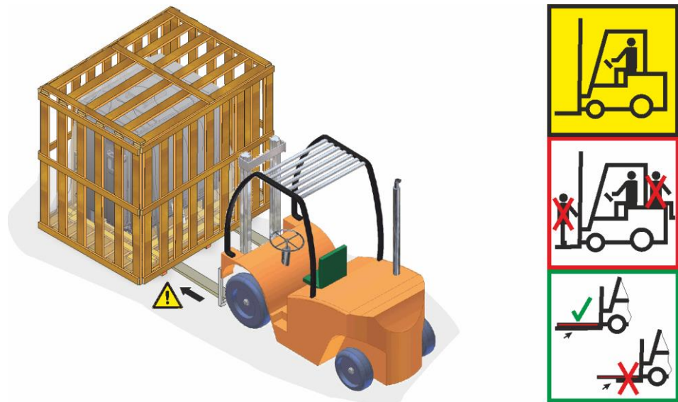
Abb. 17: Gabelstaplerzinken werden vollständig unter das Transportgestell geschoben
