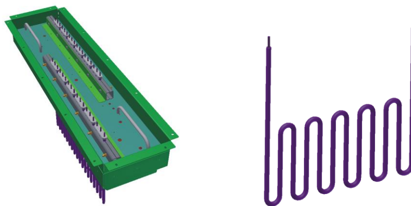
Abb. 28: Heizregister bestehend aus Rohrheizkörpern
