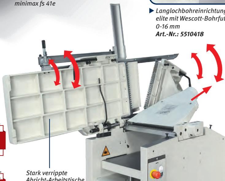
Stark verrippte Abricht-Arbeitstische aus Grauguss
