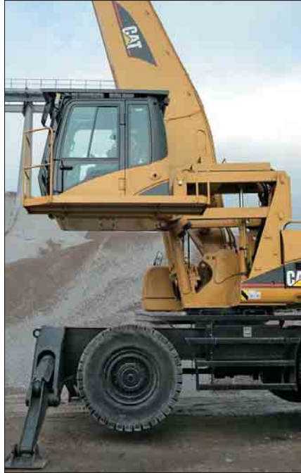
Middelste stand. In de middelste stand is de cabine 500 mm verder vooruit dan in de rijstand voor beter zicht.
