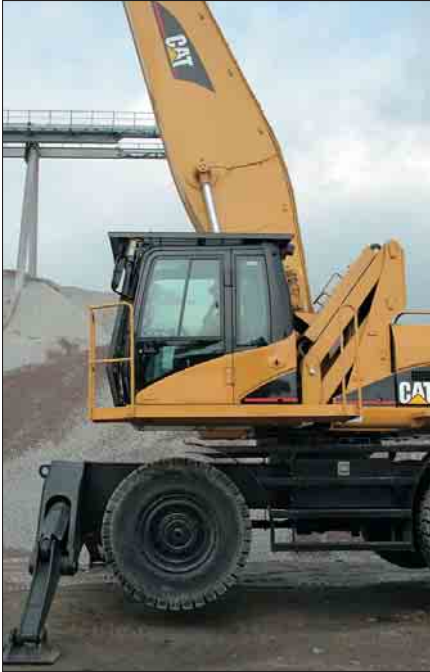
Laagste stand. De laagste stand wordt gebruikt voor vervoer en rijden.
