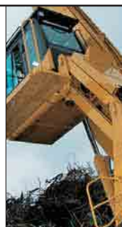
Verbeterde instap. De M325D MH en M325D LMH kunnen met een nieuw ontworpen verbeterde instap worden uitgerust. Deze cabine heeft een extra cabinebordes met leuningen die zo zijn geplaatst dat de machinist veilig kan in- en uitstappen.
