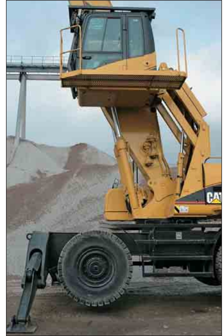
Hoogste stand. In de hoogste stand is de cabine 2600 mm geheven. Hierbij is er optimaal zicht naar alle kanten in verschillende toepassingen zoals het hanteren van schroot en lossen en laden in havens. De cabine kan op elk niveau tussen de laagste en hoogste stand worden geplaatst.
