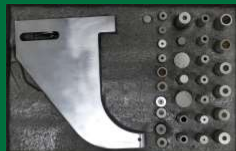
J-Aufnahme für die Bearbeitung schwer zugänglicher Einpresspositionen
