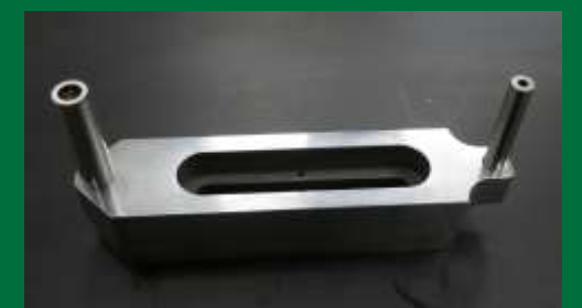
Matrizen Aufnahme mit einer schmalen Seite für komplexe Bauteile und Geometrien
