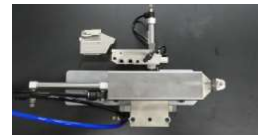
Zuführeinheit unten automatische Zuführung von Einpressmuttern zur Werkstückunterseite
