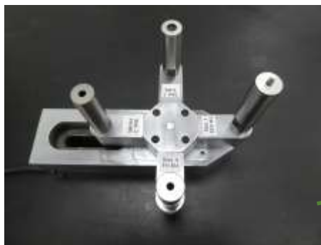
TIS- Werkzeugkarussell mit 4 Stationen und automatischem Aufruf der zugehörigen Parameter
