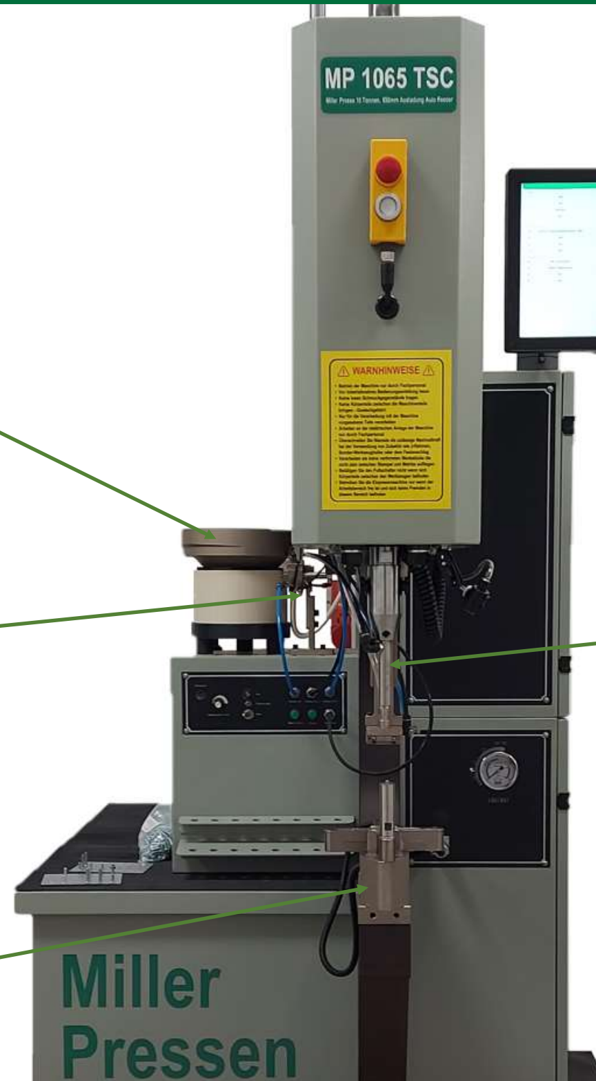
Schwingförderer zur automatischen Förderung der Befestigungselemente
