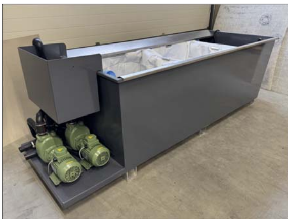
Optionales Spülsystem, Retrofit Maximator JET 05.2025
