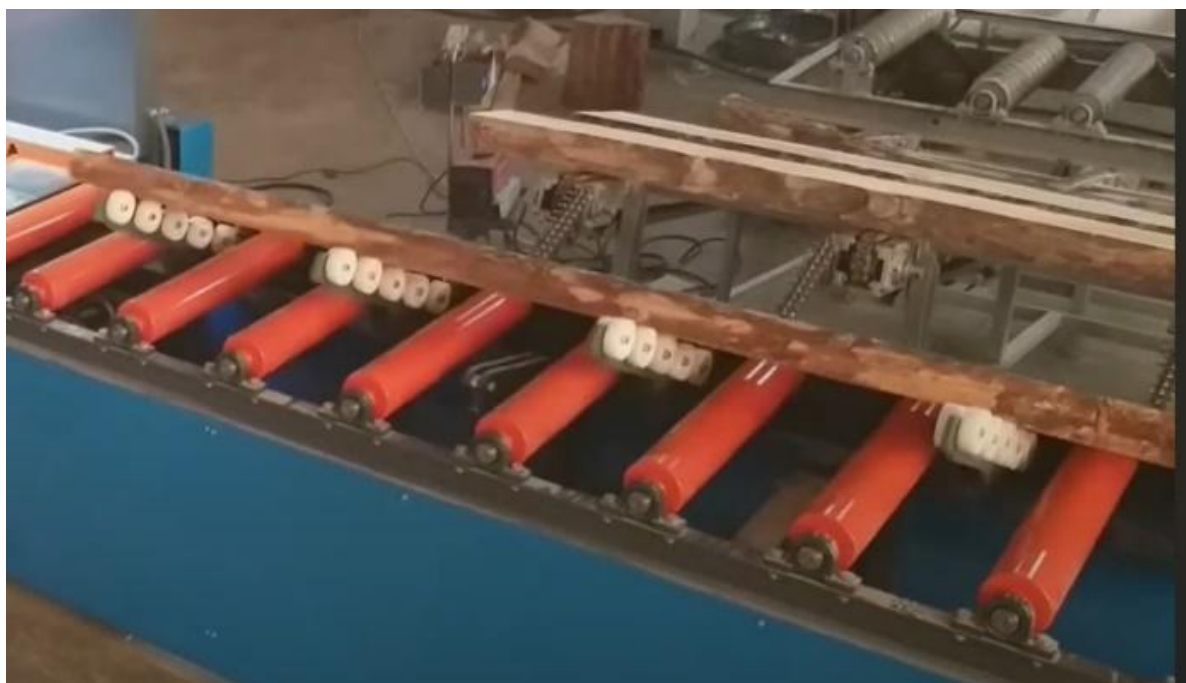
Sistem de aliniere a prismelor la alimentare.
