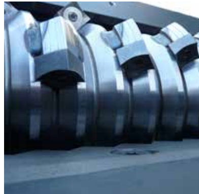
Rotor mit doppelter Messerreihe
