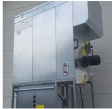
Absaugung MMJet 160 mit fahrbarem Container
