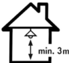
Innerhalb des Aufstellbereichs dürfen sich keine **ABHÄNGUNGEN** bzw. **GEBÄUDEELEMENTE** (Lampen/Leitungen etc.) unterhalb einer Höhe von **3 METERN** befinden.
