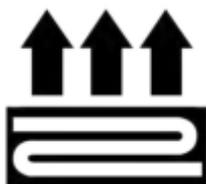
Unterhalb des Aufstellbereiches der Maschine darf sich **KEINE FUSSBODENHEIZUNG** befinden.
