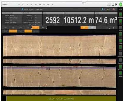
Opticore führt die Defekterkennung auf Basis der Sensorinformationen durch und optimiert das Brett nach Kundenanforderung. Es steuert eine Multi-PC-Architektur unter Windows, zur schnellen Verarbeitung der Daten.
