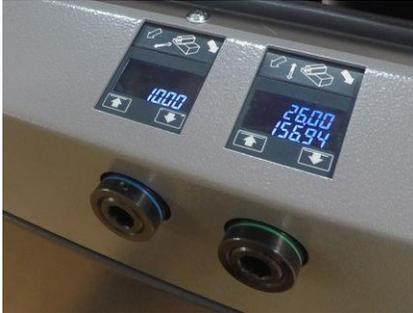
Radiale CNC - gesteuerte Verstellung und Positionierung der Werkzeugaufnahmen in Verbindung mit der Memory Funktion oder PowerCom.
