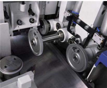
Zusätzliche Verlängerung der Pendelachse gegenüber der linken Spindel auf 150 mm.
