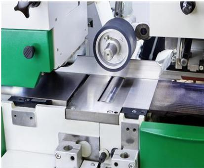
Zwei angetriebene Rollen im Maschinentisch, gehärtet
