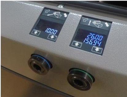
Radiale CNC - gesteuerte Verstellung und Positionierung der Werkzeugaufnahmen in Verbindung mit der Memory Funktion oder PowerCom.
