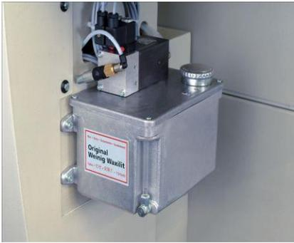
Automatische Gleitmittelpumpe zur Tischentharzung,
