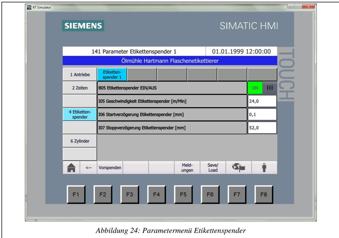
Abbildung 24: Parametermenü Etikettenspender
