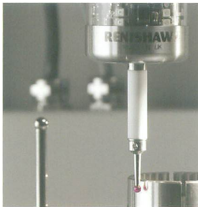
Die Messdaten werden durch ein Lichtbündel übertragen
