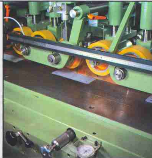
Feineinstellung der vertikalen Anschläge mit Meßuhr. Vertikale und horizontale Anpassung der Lineale und Tische an die Werkzeuge.
