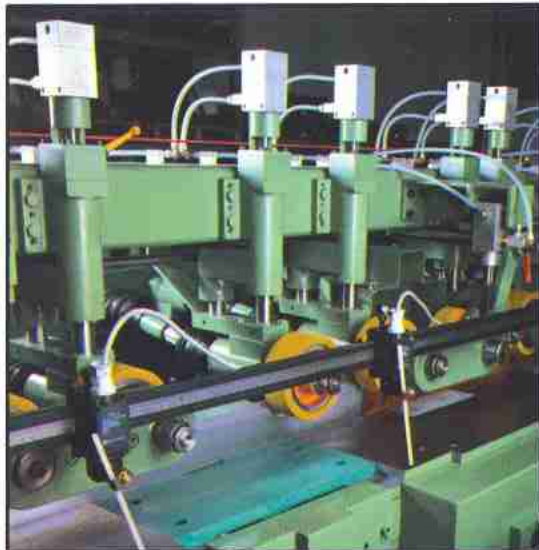
Baukastensystem: Zusätzliche untere Welle. Kardantrieb zu den Vorschubwalzen. Verstellbarer Endscharter für unterbrochene Einfräsung.
