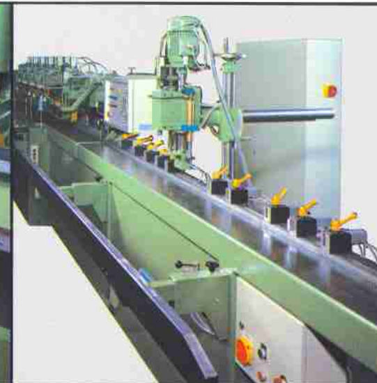
Olivenbohrgerät mit programmgesteuerten Anschlägen.
