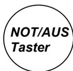
***(roter Pilztaster mit gelbem Grund) muss zur Inbetriebnahme der Maschine immer entriegelt sein. Er ist bei unmittelbarer oder drohender Gefahr sofort zu betätigen!***
