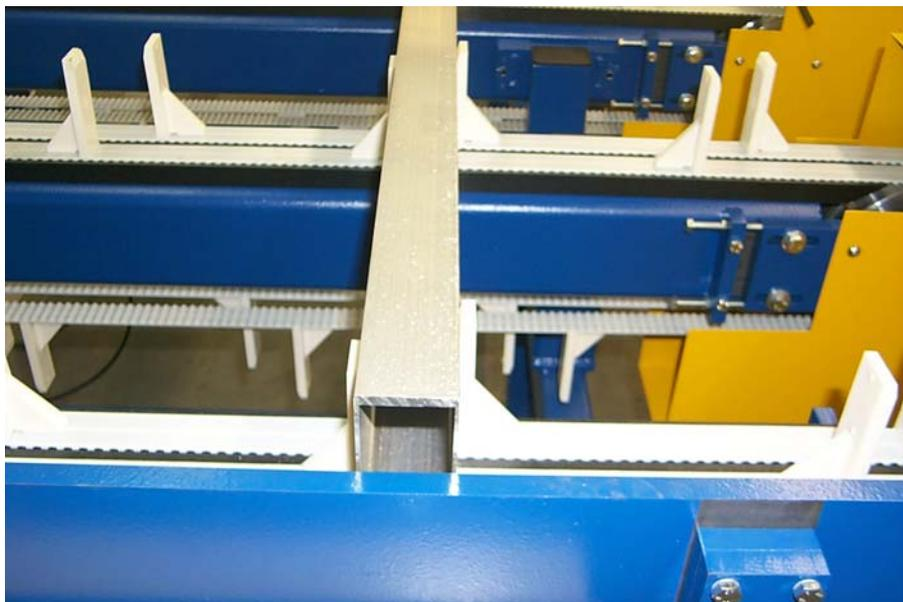
Aluminiumhohlprofil in korrekt eingestelltem Transportfach
