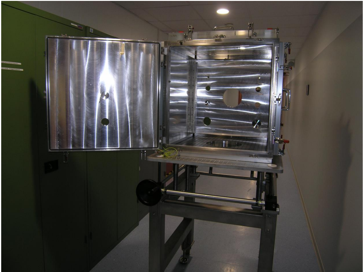
Offene Vakuumkammer; die 50 mm dicke Plexiglasscheibe auf der Oberseite ist auch hier deutlich zu erkennen.
