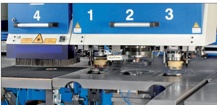
CombiLaser TRI 3 Kopf-Stanzmaschine mit 2x Revotool (Kopf 1 + 3) und Rotation/Index (Kopf 2)
