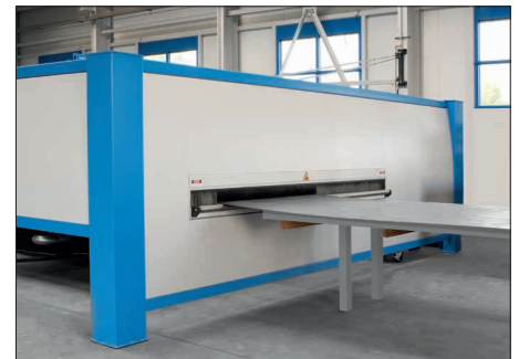
Seitliche Beladung der Bleche bei einer Umhausung
