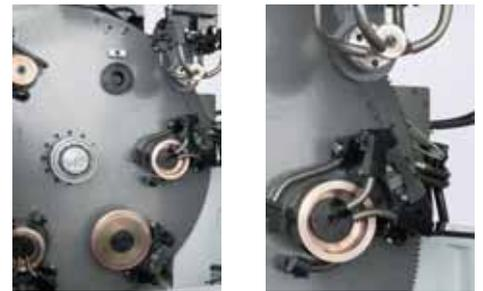
Cargador de herramientas con 6 emplazamientos para discos de erosión y muelas de afilar
