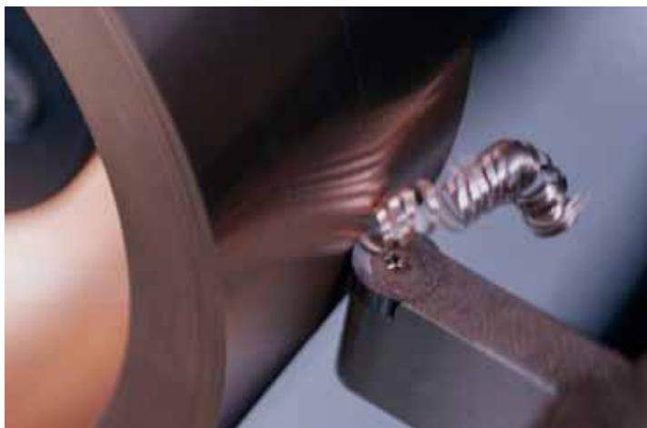
Rectificación de un disco de erosión
