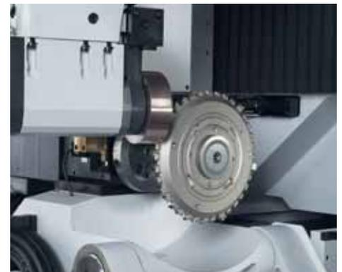
Eje E1 en posición de giro: erosión de una herramienta de mecanizado por arranque de viruta con corte a la izquierda
