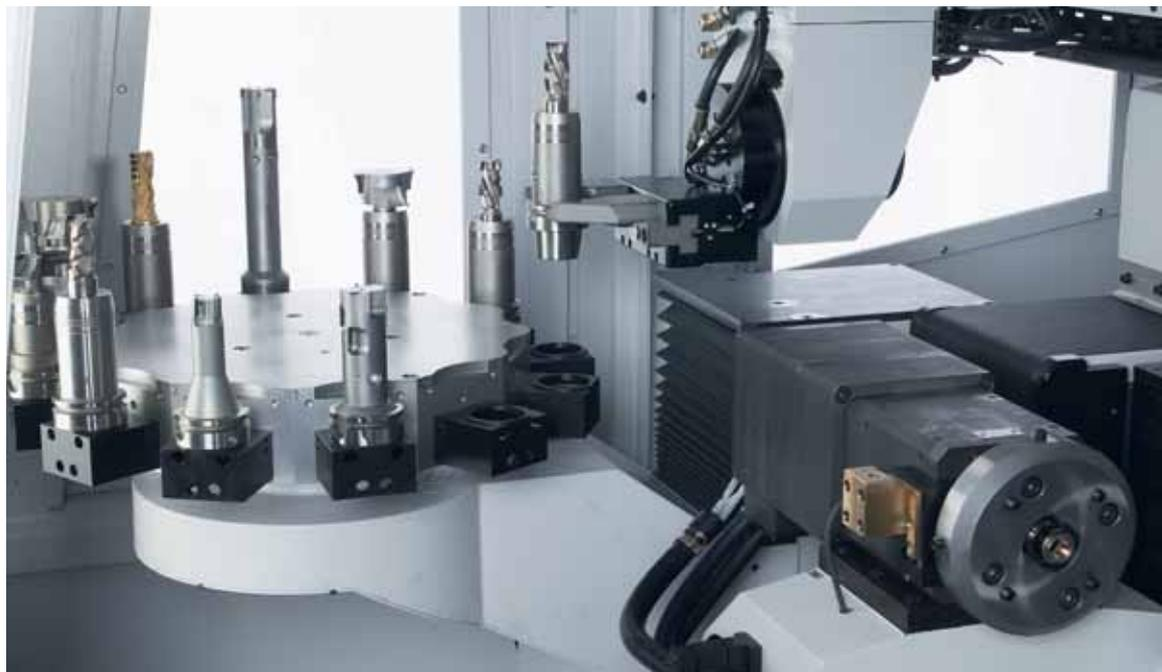
Máquina de erosión por disco con cargador
