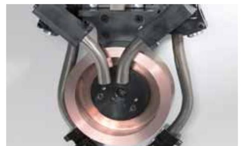
Disco de erosión con cono de sujeción HSK 63F y dispositivo de alimentación para el dieléctrico
