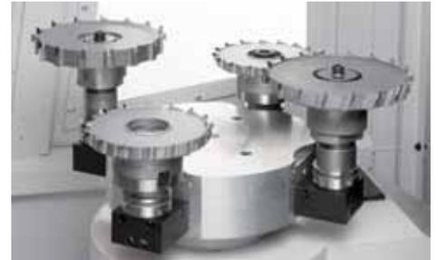
Cargador con 4 emplazamientos para piezas de trabajo grandes como por ejemplo fresas de disco (el cargador puede estar en versión doble, 8 emplazamientos)
