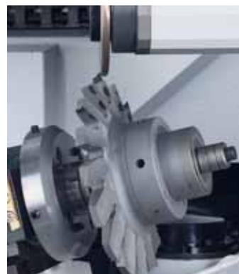
Erosión de una fresa de aplanar
