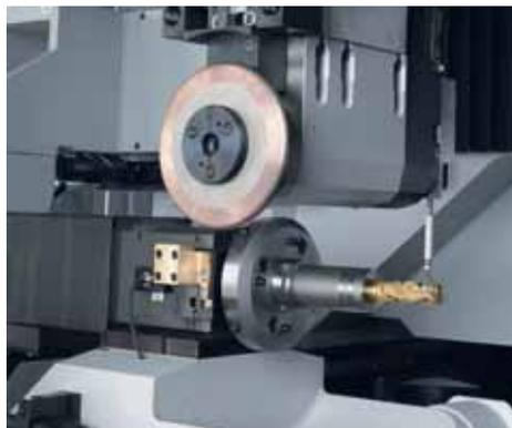
Axe E1 (zone d'orientation 330 degrés): palpage d'un outil à queue, tranchants à gauche et à droite, en un seul serrage
