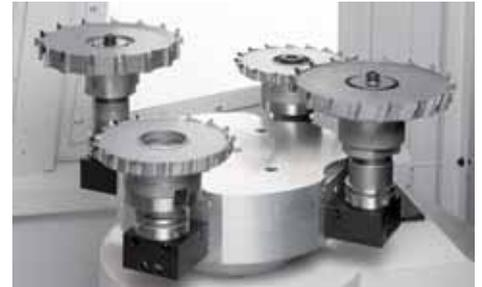
Magasin avec 4 emplacements pour pièces à usiner de grands diamètres telles que les fraises disques (le magasin peut être proposé en version double, soit 8 emplacements)
