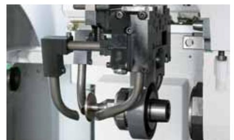
Electrode d'érosion avec système de serrage HSK 63F et dispositif d'arrosage pour le diélectrique
