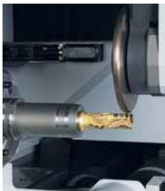
Usinage d'une fraise à défoncer avec une électrode périphérique
