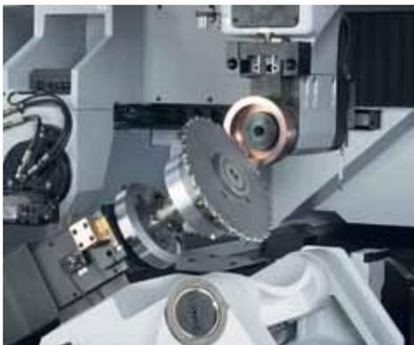
Axe B1 (zone d'orientation +/-30 degrés): érosion d'un outil avec une électrode boisseau
