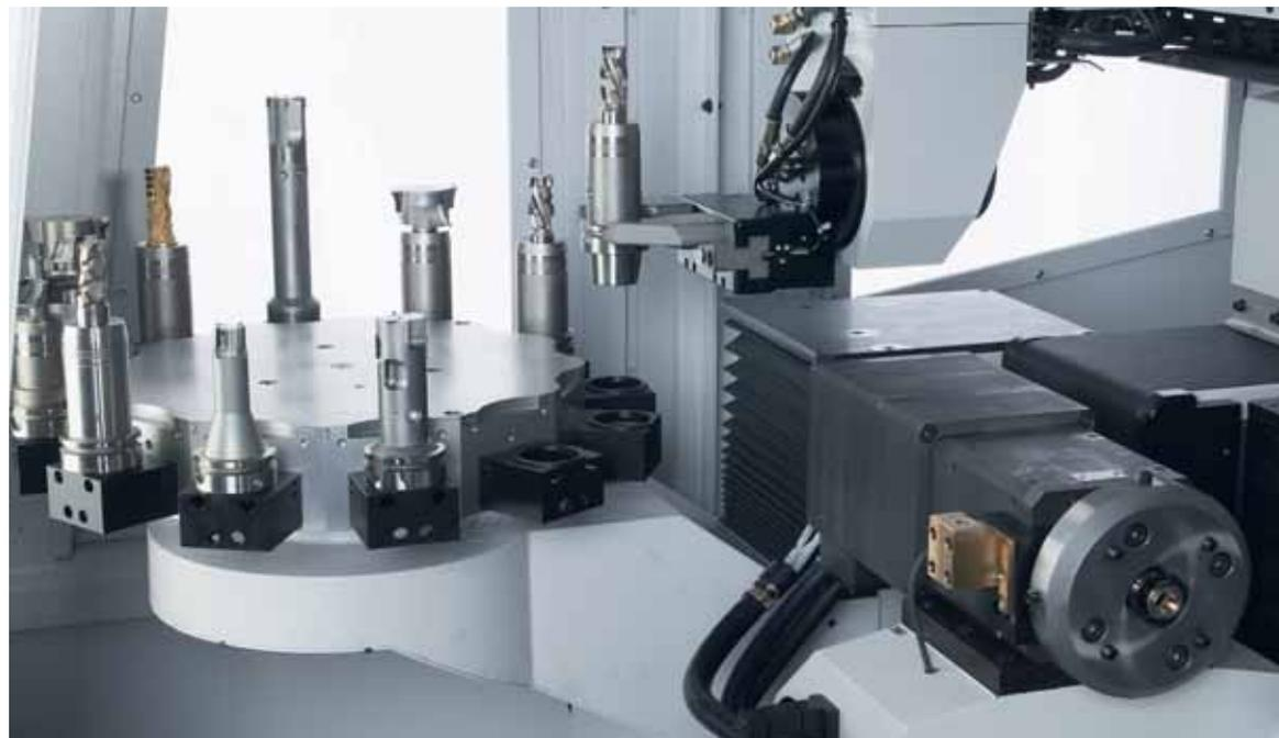
Machine d'érosion par électrode rotative avec magasin
