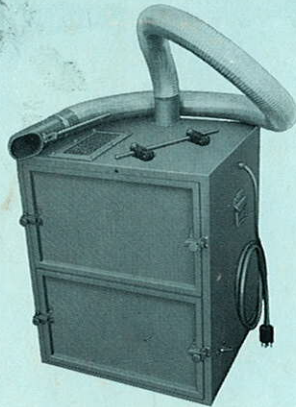
S 30 Staubabsaugung mit 24 eingebauten Filtertaschen, eingebautem Ventilator und Drehstrommotor 0,5 PS, Staubabklopfvorrichtung, ausziehbarem Staubsammelkasten, Absaugeschlauch und Mundstück
