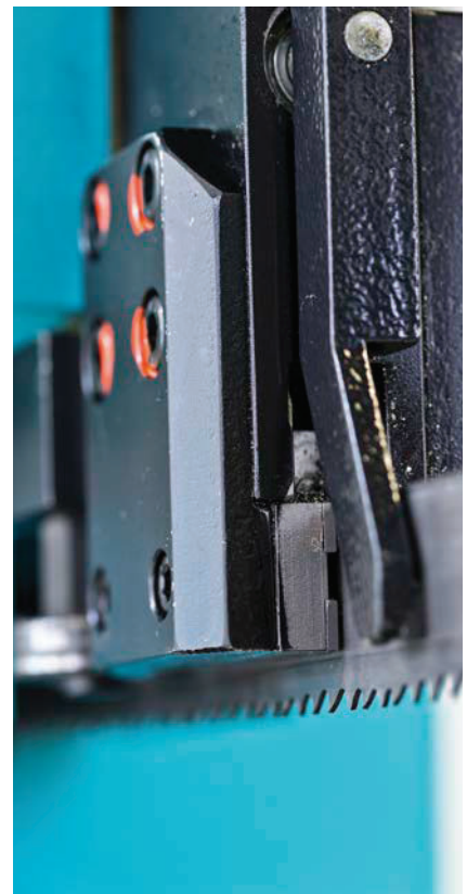
Hartmetallbestückte Sägebandführungen für höchste Schnittgenauigkeit.
