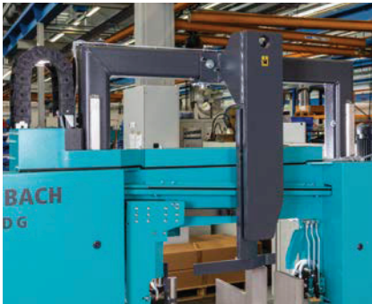
Sägerahmen in spielfrei vorgespannten Rollenlinearführungen laufend.
