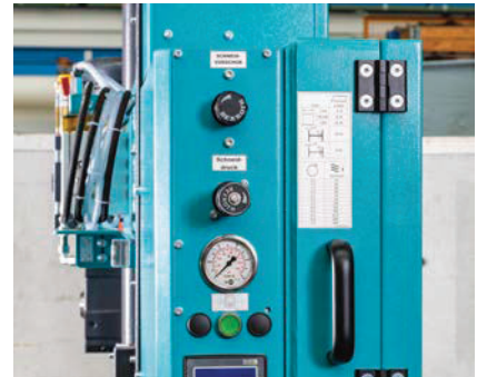
Hydraulischer Sägebandvorschub, stufenlos einstellbar.
