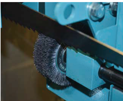
Separat angetriebene Spänebürste.
