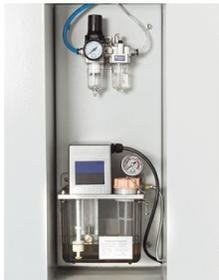
Zentralschmiereinrichtung und Wartungseinheit
