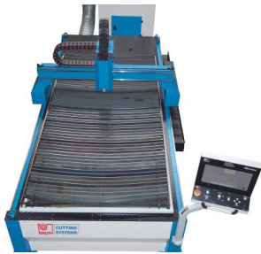
Das Werkstückgewicht wird durch Auffanggitter getragen. Diese können nach Ablauf ihrer Nutzzeit problemlos nachgefertigt werden
