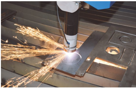
Schneidbrenner mit Magnetkupplung und Crashesensor
